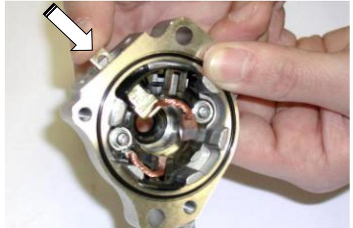
INSTALL NEW BRUSH TERMINAL INSIDE PLACE LITTLE RUBBER CAP ON THE TERMINAL.
